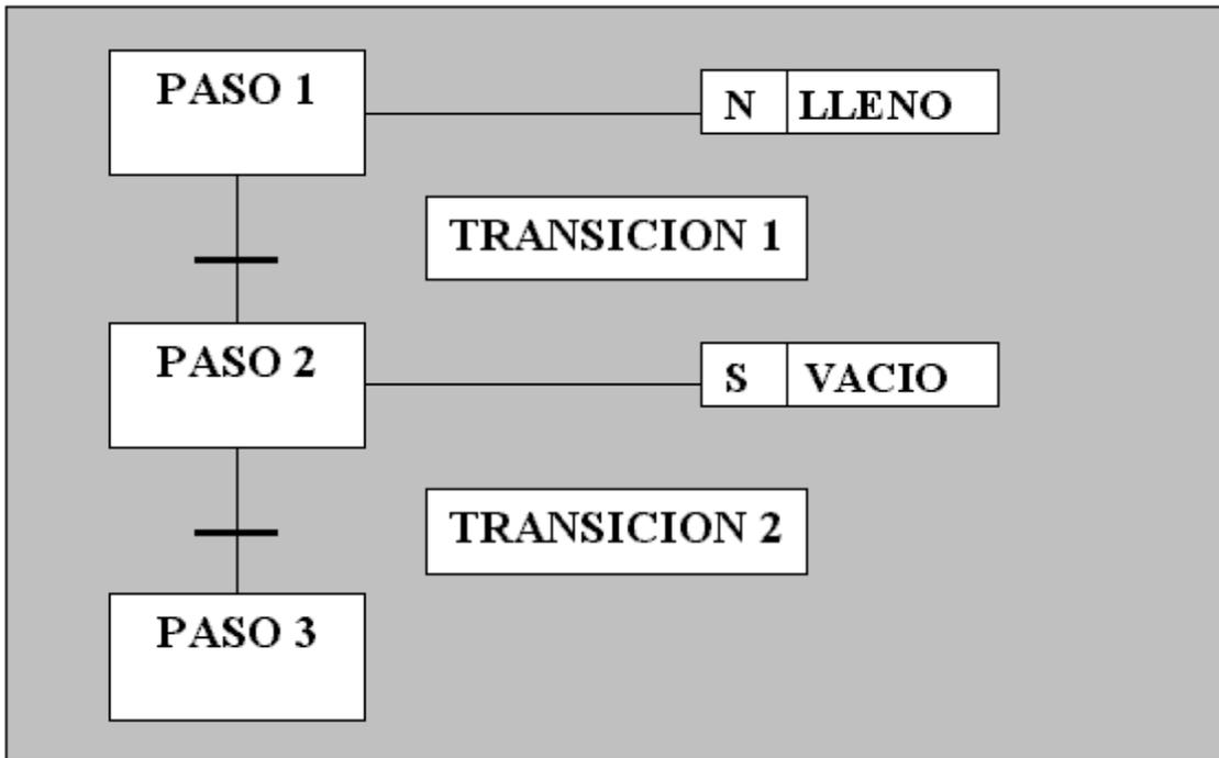
Las SFC apoyan las secuencias alternativas y paralelas, tal como son requeridas en las aplicaciones batch. Por poner un caso, una secuencia es usada para el proceso primario y una segunda monitorea las acciones de operación general del programa. Y esto ocurre con la misma sobre visión y estructura.
