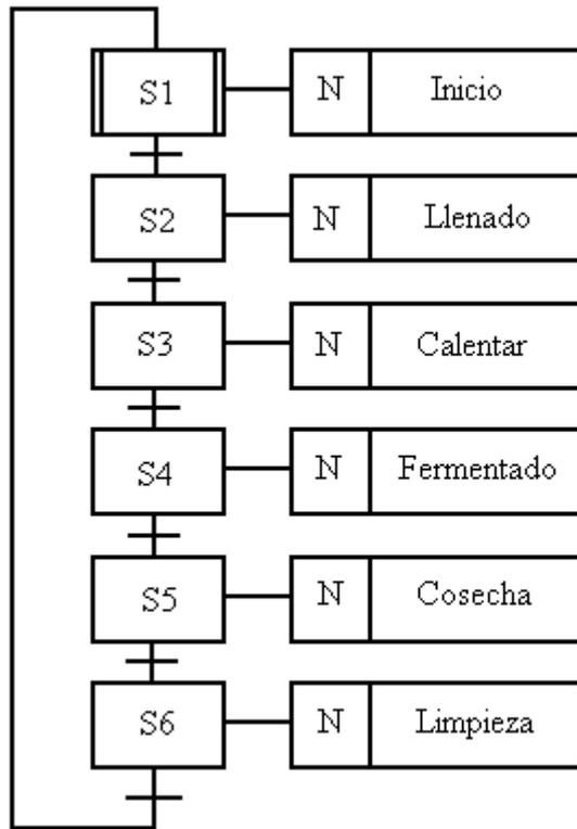
Nosotros empezamos arriba con la inicialización: sin conocer el estado del sistema, cuando lo encendemos, nosotros debemos testar el estado de las válvulas, etc.
